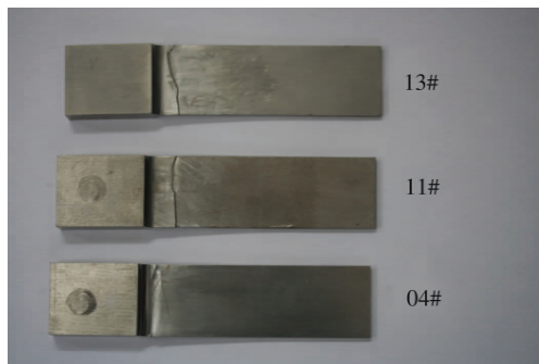
图6 模拟叶片断裂位置
